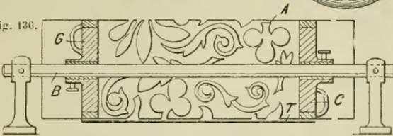
pinceaux F agissant sur le tissu à travers des jours du cylindre, et à l'intérieur du bain de teinture. Il sera avantageux de fixer de la même manière des tampons G agissant à la partie supérieure du cylindre pour essuyer les bavures que la teinture pourrait laisser dans les jours. L'extérieur du cylindre sera essuyé de la même manière par un tampon H.
